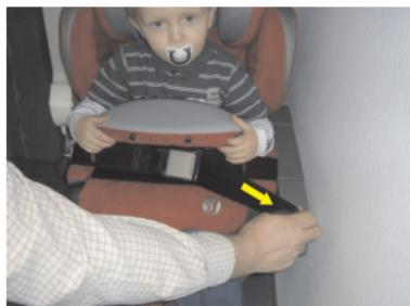
Straffen Sie den Gurt, indem Sie an dem losen Ende ziehen.
