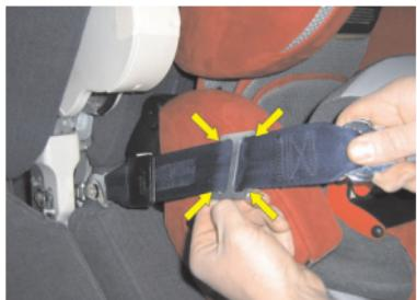
Fädeln Sie den Gurtverkürzer auf den Gurt bis alle 4 Haken hinter dem Gurt liegen (gelbe Pfeile).
