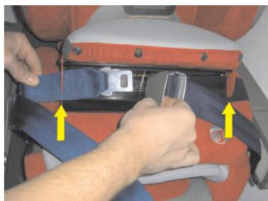
Enfilez les ceintures dans les orifices de guidage de la ceinture et fermez la boucle de ceinture.
