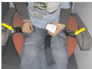
Insérez les deux extrémités de la ceinture abdominale dans les orifices de guidage de la ceinture situés sur le siège.
