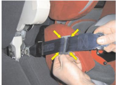
Enfilez la pince de sécurité sur la ceinture jusqu'à ce que les 4 crochets soient bien placés derrière la ceinture (flèches jaunes).
