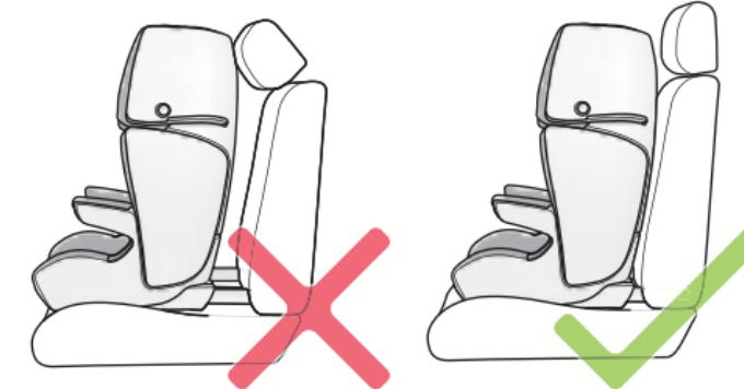
В автомобилях, оборудованных подголовниками, возможно, потребуется регулировка или демонтаж подголовников для облегчения установки детского автомобильного сиденья. Обратите внимание, что подголовники автомобиля должны быть установлены на место или отрегулированы в исходное положение, если поездку совершают взрослый пассажир.
