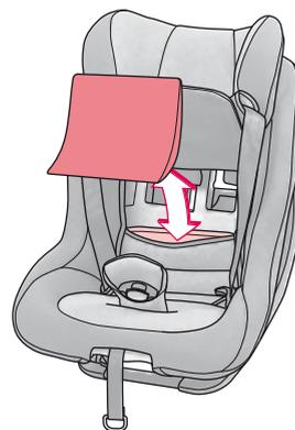
Если вес ребёнка больше 8 кг, установленный тазовый вкладыш следует вынуть. Он находится в кармане под сиденьем на задней стороне обивки.
