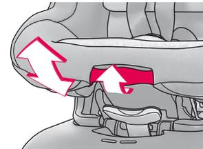
Поверните рычаг регулирования угла наклона спинки сиденья (05) на передней части чаши вверх и приведите сиденье в нужное положение. Когда вы отпустите рычаг (05), чаша сиденья зафиксируется.
