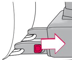
Снимите CONCORD ULTIMAX с сиденья автомобиля.
