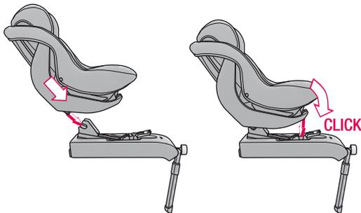
Затем сложите чашу сиденья вперёд, чтобы передний фиксатор чаши (11) со щелчком закрылся на основании ISOFIX, а индикатор безопасности (07) на верхней стороне стал зелёным.
