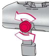
Поверните кнопку ISOFIX SYSTEM (08) на передней стороне основания CONCORD ULTIMAX ISOFIX влево, чтобы переходники ISOFIX (15) на задней стенке выдвинулись полностью.
