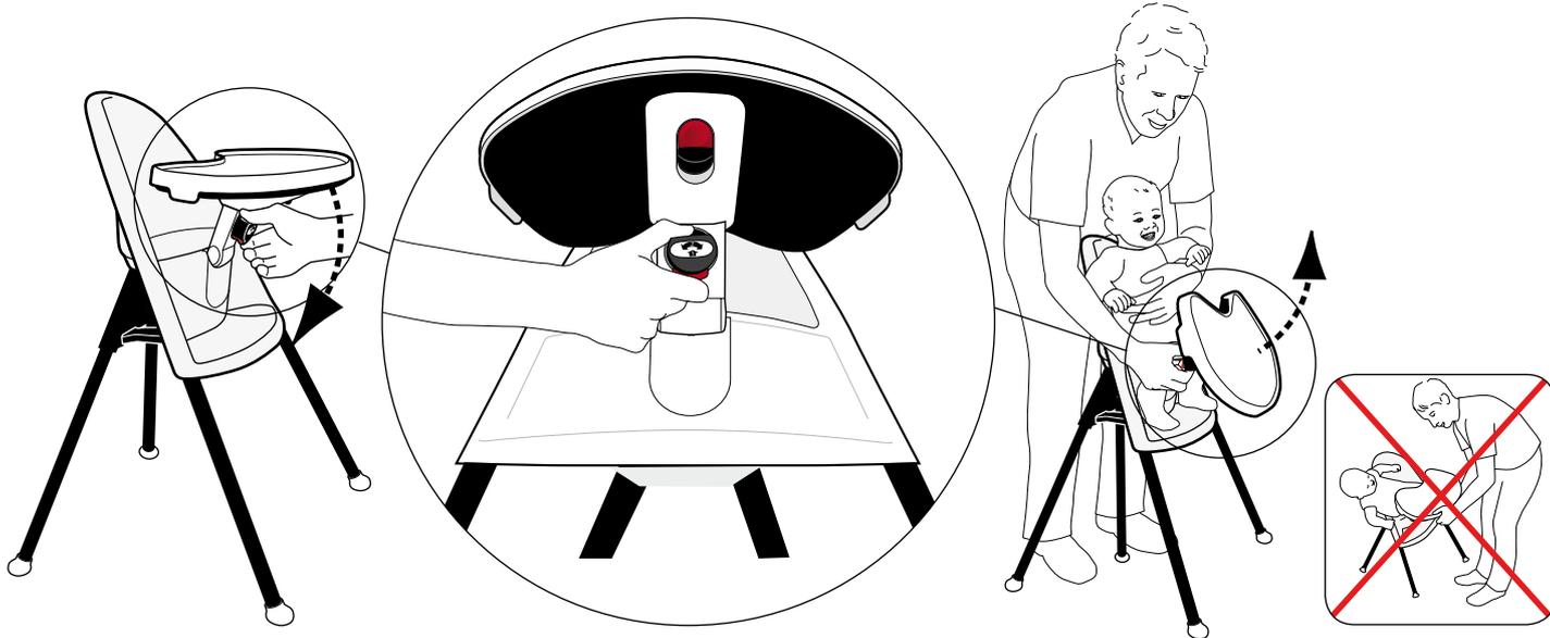
1. Нажмите защелку безопасности, а затем поверните поворотную кнопку, чтобы столик безопасности опустился в открытое положение.
