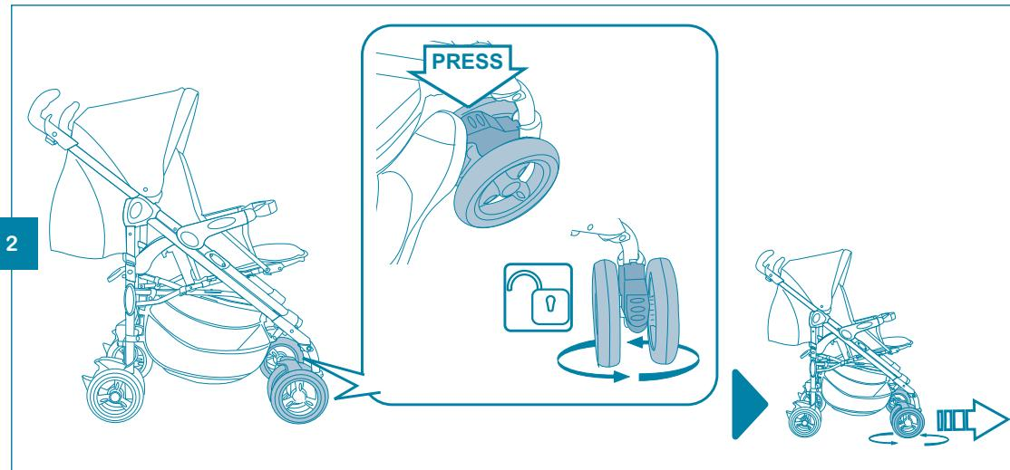
Utilizzo del sistema di frenatura • Using the brake • Bremssystem • Utilisation du système de freinage • Utilizar el freno • Utilização do sistema de travagem • Uporaba zavore • Używanie hamulca • A fék használata • Upotreba kočnice • Использование системы тормозов • Hur man använder bromsen • Gebruik van het remssysteem • Χρήση του φρένου • Modul de folosire al franelor
