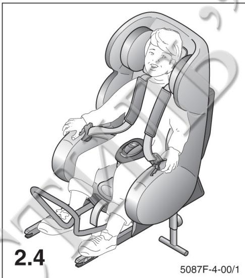
Закройте замок, соединив оба язычка друг с другом (1) и зафиксируя их в замке до отчетливого щелчка (2).
