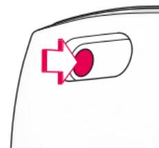
Для регулировки сиденья CONCORD TRANSFORMER по росту ребенка нажмите несильно вниз на подголовник (01). Теперь нажмите кнопку регулировки размера сиденья (05) на задней
