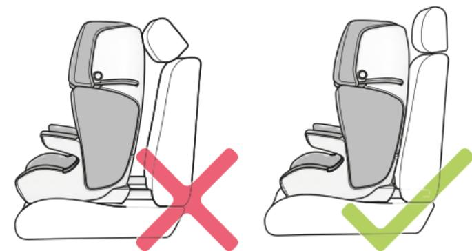
В автомобилях, оборудованных подголовниками, возможно, потребуется регулировка или демонтаж подголовников для облегчения установки детского автомобильного сиденья. Обратите внимание, что подголовники автомобиля должны быть установлены на место или отрегулированы в исходное положение, если поездку совершает взрослый пассажир.
