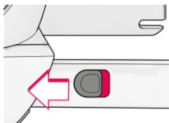
Для снятия сиденья CONCORD TRANSFORMER вытяните вперед кнопку TWINFIX (09) и до конца выдвиньте сиденье вперед. Затем сдвиньте вперед фиксирующие кнопки, расположенные на внешних сторонах адаптеров TWINFIX (10), до тех пор, пока не появятся индикаторы безопасности красного цвета. Теперь потяните детское сиденье вперед и освободите его от креплений ISOFIX.
