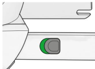
Удерживая кнопку TWINFIX (09) в вытянутом положении, подвиньте сиденье CONCORD TRANSFORMER, как можно плотнее, к спинке сиденья автомобиля. После того как детское сиденье установлено в требуемое положение, отпустите кнопку TWINFIX (09).
