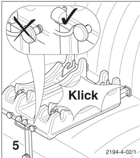
Зафиксируйте соединительные разъемы Isofix в скобах Isofix. Красная отметка на кнопках разблокировки должна исчезнуть из вида! Проверьте правильность крепления, потянув платформу на себя с двух сторон.
