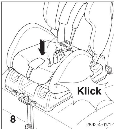
Закрепите детское сидение в переднем фиксаторе. Попробуйте приподнять сидение, чтобы проверить надежность крепления спереди и сзади.
