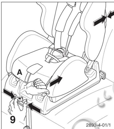
Нажмите обе зеленые кнопки (А), чтобы разблокировать первый фиксатор. Теперь система без нажатия зеленых кнопок может быть смещена назад в сторону обшивки автомобильного сидения.
