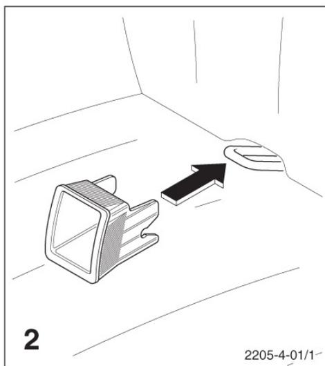
Вставьте направляющие через гнездо в обшивке между спинкой сидения и самим сидением, после чего закрепите их на скобе Isofix. Проведение данной процедуры не требуется в автомобилях с предварительно установленными направляющими, например БМВ. Обратите внимание на то, чтобы открытая боковая поверхность находилась сверху.
