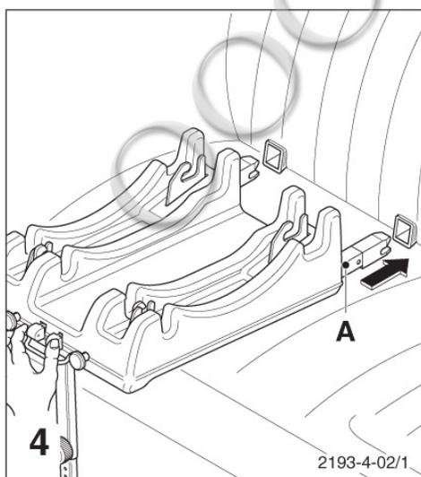
Соединительные разъемы Isofix можно извлечь при нажатии зеленых кнопок. Данное действие должно выполняться при каждой повторной установке в другом автомобиле.
