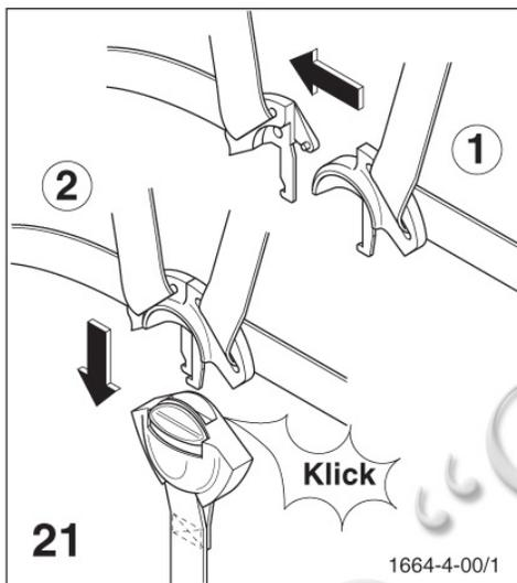
Закройте замок, соединив оба язычка друг с другом (1) и зафиксировав их в замке до отчетливого щелчка (2).
