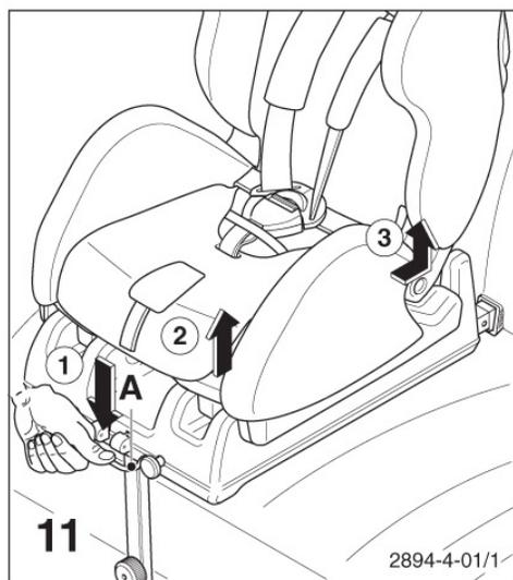
Нажмите рычаг разблокировки (A) для передних фиксаторов и приподнимите сидение. Сместите детское сидение немного назад, после чего извлеките его вверх.
