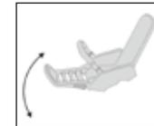
Fußkastenarretierung drücken und gedrückt halten, der Fußkasten kann in 3 verschiedenen Positionen eingestellt werden.
