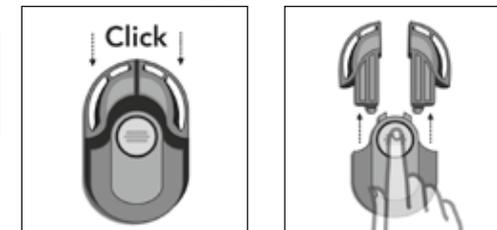
Ramenní popruhy můžete nastavit ve 3 úrovních. Vždy použijte polohu nejbližší úrovni ramen vašeho dítěte. Popruh otevřete stisknutím středového tlačítka na přezce. Ramenní a pasové popruhy nastavíte tažením za volné konce pásů.
