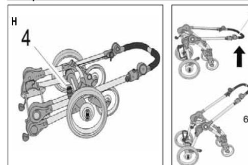
Разомкните специальный замок **4** и тяните за ручку **5** вверх, пока не услышите небольшой щелчок, который обозначает, что конструкция зафиксирована в нужном положении **6**.
