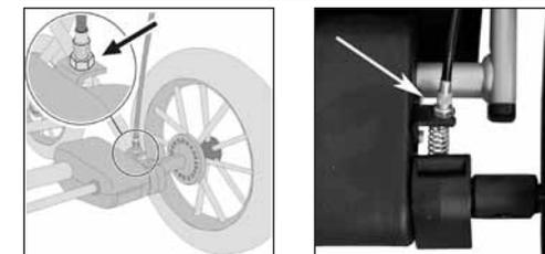
Si nota algún cambio en el efecto de frenado, afloje primero la contratuerca para proceder a continuación reajustarlo con el tornillo de ajuste (desenroscándolo). Después fije de nuevo la contratuerca.
