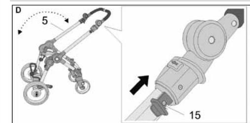
Vedän aisan kummankin puolen varmistinta (15) nuolen suuntaan ja pidä vedettynä. Aisa voidaan kääntää toiseen asentoon.
