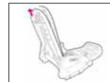
Потянуть фиксатор спинки вверх, чтобы отрегулировать наклон (4 положения "сидя" и "лежа" + два дополнительных положения полужёжа).
