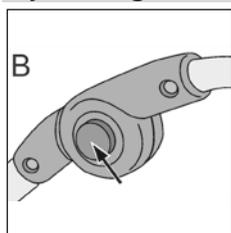
Håll in spärren på båda sidor och ändra handtaget till önskat läge.
