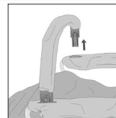
Stick in instickningsdelen av skyddsbygeln genom slitsarna i sitsöverdraget in i de underliggande hållarna
