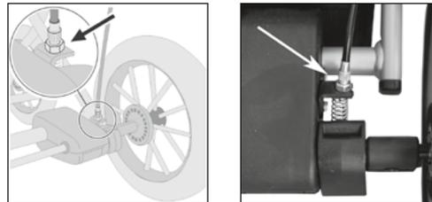
Sollten Sie eine Veränderung der Feststellwirkung bemerken, dann lösen Sie zunächst die Kontermutter um Einstellungen an der Stellschraube vornehmen zu können (heraus drehen). Anschließend die Kontermutter wieder fixieren.
