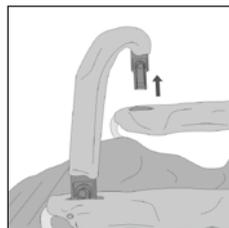
Introduisez les parties repliables de l'arceau de sécurité par les rainures de la garniture de siège dans les guides sous-jacents dans les accoudoirs. Veillez à ce que l'arceau de sécurité s'encliquète des deux côtés. Afin d'enlever appuyez sur les boutons de déverrouillage sur les parties repliables. Afin de faciliter la montée et la descente de voiture de votre enfant, il suffit de desserrer un côté de l'arceau et de relever.
