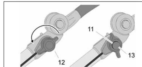
Dźwignię hamulca (12) należy przekręcić zgodnie ze strzałką aż do zatrzaśnięcia. Gdy pojawi się czerwony pierścień (11), blokada hamulca jest uruchomiona.
