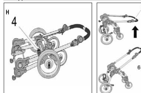
Trykk på transportsikringen (4) og slå opp vognen med det svingbare skyvehåndtaket (5) til det smekker på plass i den stillingen (6) som er vist.
