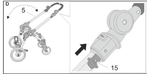
Trekk sikringen (15) på begge sider av det svingbare skyvehåndtaket og hold dem fast. Det svingbare skyvehåndtaket kan da svinges henholdsvis til den ene eller andre stillingen.
