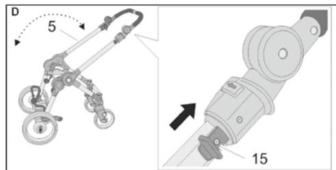
Po obou stranách zatáhněte za pojistku (15) na sklopné rukojeti ve směru šipky a přidrže ji, sklopnou rukojeť je nyní možné překlápnout na opačné polohy.
