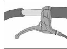
Модели с замедляющим тормозным механизмом: для срабатывания замедляющего тормоза нажать рукоятку тормоза на ручке коляски. Регулирование тормозного действия производится с помощью установочного винта на тормозном рычаге коляски.
