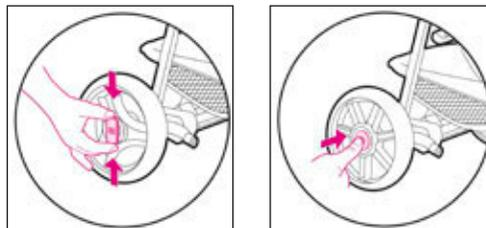
Per fissare la ruota, spingerla sull'asse.
