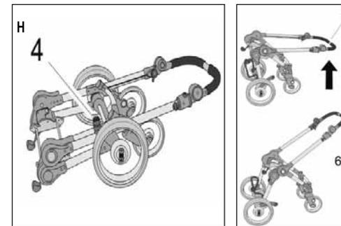
Stiskněte přepravní pojistku (4) a rozevřete kočárek pomocí sklopné rukojeti (5) tak, aby bylo slyšet zajištění ve znázorněné poloze (6).
