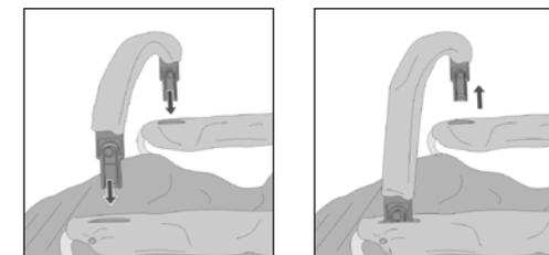
Zasuňte zásuvní díly pojistní úchytky přes drážky v potahu sedadla do pod ním se nacházejících uchycení v loketní opěrce. Dbejte na to, aby pojistní úchytka zaskočila v západce na obou stranách. K odebraní stlačte odblokovací tlačítka na zásuvných dílech. Aby jste ulehčili vystupování a nastupování Vašeho dítěte, postačuje, když uvolníte a vyklopíte nahoru jednu stranu úchytky.
