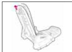
Tirare verso l'alto il dispositivo di bloccaggio dello schienale per regolare l'inclinazione (4 posizioni seduto/sdraiato + la posizione di chiusura davanti).
