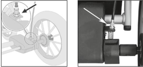
Mikäli havaitset, että jarrujen pito on muuttunut, löysää ensin lukkomutteri, jotta voisit säätää säätöruuvia (kierrä ulos). Kiristä lukkomutteri säätämisen jälkeen.
