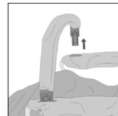
Inserire le parti maschie del corrimano di sicurezza, attraverso le fessure nell'imbottitura della seduta, nelle sottostanti sedi sui braccioli. Fare attenzione a che il corrimano di sicurezza scatti su entrambi i lati. Per rimuoverlo, premere i bottoni di sblocco sulle parti maschie. Affinché il bambino possa salire e scendere più facilmente è sufficiente aprire il corrimano su un lato e ribaltarlo.
