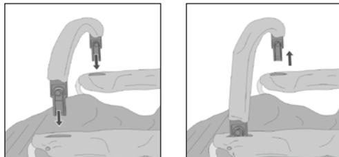
Należy umieścić elementy wtykowe (przez szczeliny w pokrowcu siedzenia) w umieszczone poniżej gniazda w podłokietnikach. Należy zwrócić uwagę na to, by pałak ochrony zatrzasnął się prawidłowo po obu stronach. Aby zdjąć pałak należy nacisnąć przyciski guzikowe umieszczone przy elementach wtykowych. Aby ułatwić dziecku wsiadanie i wysiadanie wystarczy poluzować i odchylić do góry pałak tylko z jednej strony.
