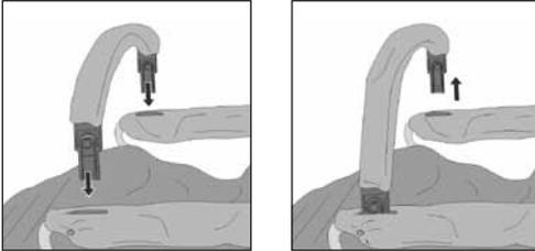
Вставьте направляющие защитной дуги в специальные пазы на подлокотниках. Убедитесь, что дуга надежно закреплена с обеих сторон. Дабы снять этот элемент, нажмите специальные кнопки на направляющих. Чтобы облегчить процесс посадки и высадки ребенка из коляски, высвободите всего один конец защитной дуги и откиньте ее в сторону.
