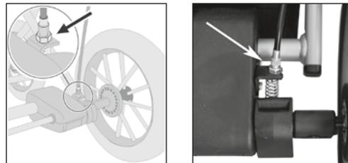
Hvis der registreres en ændring af bremsefunktionen, løsnes først kontramøtrikken for at kunne foretage indstillinger på stilleskruen (drej udad). Herefter kan kontramøtrikken strammes igen.
