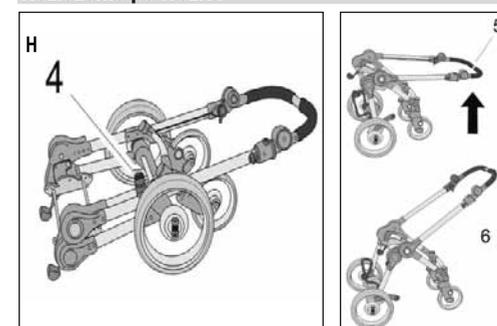
Uvoľnite cestovný zámok (4) a pomocou výkyvnej rukoväte (5) rozložte kočík tak, aby bolo počuť zacvaknutie do znázornenej polohy (6).
