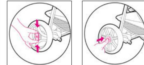
Skub hjulet på akslen for montering. Kontrollér, at hjulet er korrekt fastlåst ved at trække i det!
