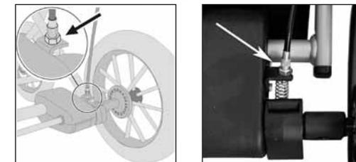
Ak zistíte zmenu akcie brzdenia, najprv uvoľnite poistnú maticu, aby bolo možné upraviť nastavenie pomocou príslušnej skrutky (povolenie). Potom poistnú maticu znovu nasadte.
