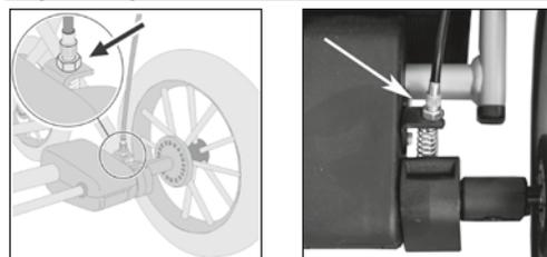
V případě, že zaznamenáte změnu účinnosti brzdy, tak nejdříve uvolněte pojistnou matici, abyste mohli provést nastavení pomocí stavěcího šroubu (vyšroubovat). Nakonec pojistnou matici znovu zafixovat.
