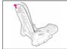
Tirar del dispositivo de bloqueo del respaldo hacia arriba para ajustar la inclinación (4 posiciones de inclinación del asiento + posición de plegado completamente hacia delante).
