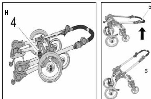
Transportbeveiliging (4) indrukken en wagen aan de zwenkbare duwstang (5) open klappen totdat hij hoorbaar in de afgebeelde positie (6) vastklikt.
