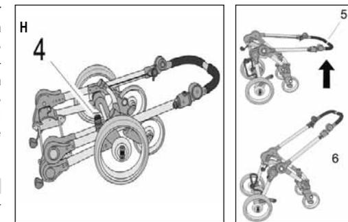
Accionar el seguro de transporte (4) y plegar el cochecito por el manillar basculante (5) hasta que se escuche como se enclava en la posición que se muestra en la ilustración (6).
