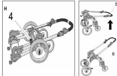
Transportsicherung (4) betätigen und Wagen am Schwenschieber (5) aufklappen bis er hörbar in abgebildeter Position (6) einrastet.
