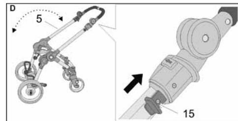
Tirar y seguir tirando de ambas partes del manillar basculante (15) en la dirección de la flecha; el manillar basculante puede moverse hasta cada una de las otras posiciones.
