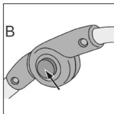
Нажмите регулировочные кнопки с обеих сторон и, удерживая их нажатыми, отрегулируйте высоту ручки.
