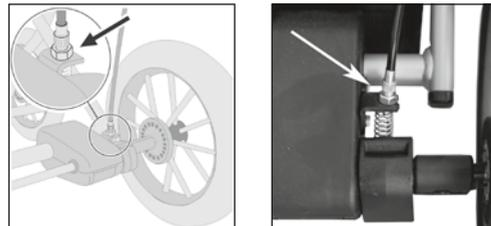
Ja pamanāt izmaiņas bremzēšanas darbībā, vispirms atslābiniet uzgriezni, lai varētu veikt regulēšanas skrūves iestatījumus (atskrūvēt to). Pēc tam atkal uzskrūvējiet bloķējošo uzgriezni.
