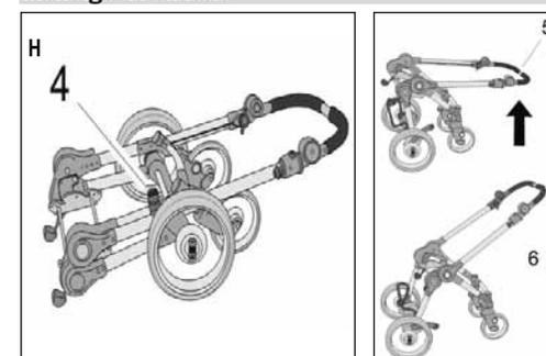
Actionner la fixation de transport (4) et replier la poussette au niveau de son guidon réversible (5) jusqu'à ce qu'il s'encliquette de manière audible dans la position illustrée (6).
