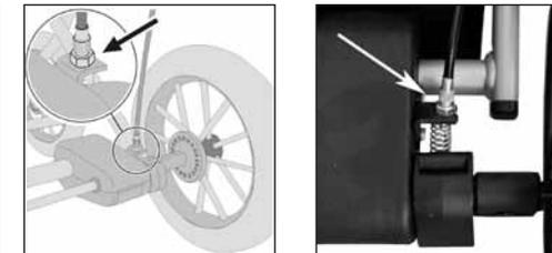
W przypadku zauważenia zmian w działaniu hamulca, najpierw należy odkręcić przeciwnakrętkę, aby móc wyregulować ustawienie za pomocą śruby regulacyjnej (wykręcić). Następnie z powrotem dokręcić przeciwnakrętkę.
