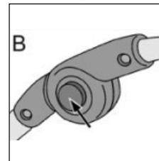
Mantenga pulsados los botones de regulación situados a ambos lados y regule la altura del manillar hasta que alcance la posición deseada.
