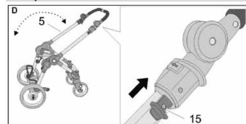
Tirer la sécurité (15) dans le sens de la flèche des deux côtés du guidon réversible et la maintenir tirée, le guidon réversible peut être pivoté dans l'autre position respective.
