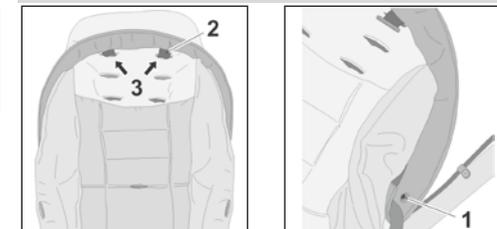
Sæt overdelen (sportsvognssæde hhv. bæretaske) således på barnevognsstellet, at overdelens sidebøjle **1** på hver side af stellet går i indgreb i de to slidser **2**, og skub derved overdelen frem til anslag. Låseanordningerne lukker så automatisk. (Der skal høres et „klik“ fra låsen)
