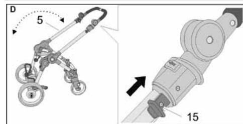
Tirare in direzione della freccia, e mantenere tirato, su entrambi i lati del manico ribaltabile il fermo (15). E' possibile ruotare il manico ribaltabile nella posizione opposta.
