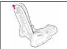
Tirer vers le haut le dispositif de blocage du dossier de siège pour régler l'inclinaison (4 positions allongée/assise + position repliée complètement vers l'avant).
