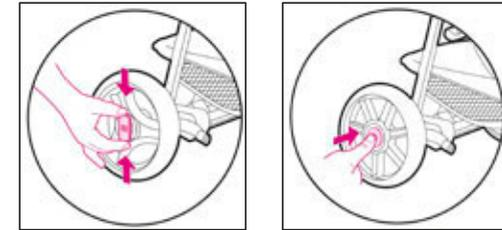
Zur Montage schieben Sie das Rad auf die Achse. Kontrollieren Sie durch Ziehen, ob das Rad korrekt arretiert ist.
