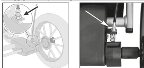
Skulle du märka en förändring på parkeringsbromsen lossar du på kontramuttern för att utföra ändringar på justerskruven (dra ut den). Därefter drar du åter fast kontramuttern.
