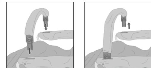
Stikk festene av frontbøylen gjennom åpningene i setetrekket og inn i åpningene på armlenene. Pass på at frontbøylen smekker på plass på begge sider. Trykk på utløserknappene på bøylen for å ta den av. For å gjøre det enklere for barnet å komme inn og ut, er det tilstrekkelig å bare løsne en side av bøylen, og så vippe den oppover.
