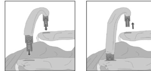
las piezas insertables de la barra de protección por las ranuras que hay en el acolchado de los reposabrazos e introdúzcalas en los alojamientos de debajo. Asegúrese de que la barra de protección ha encajado en los dos lados. Para desmontarla, presione los botones de desbloqueo que hay en las piezas insertables. Para que el niño pueda subirse y bajarse con facilidad de la silla, basta con soltar la barra de protección por un lado y levantarla.
