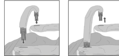
Työnnä turvakaaren kiinnitysosat istuinkankaassa olevien lovien läpi ja kiinnitä ne käsinojissa oleviin kiinnikkeisiin. Huolehdi siitä, että turvakaari lukittuu molemmilla puolilla. Kun haluat ottaa turvakaaren pois, paina kiinnitysosien vapautusnuppeja. Lapsen vaunuun asettamisen/vaunuista ottamisen helpottamiseksi turvakaari on suunniteltu siten, että se täytyy avata ja kääntää ylös vain toiselta puolelta.
