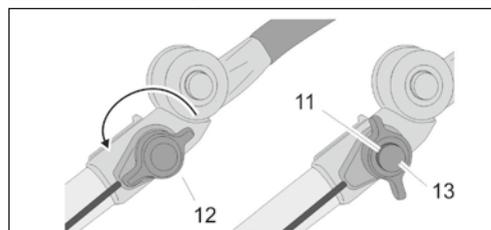
Páku brzdy (12) otočte ve směru šipky až zaklapne, objeví se červené kroužek (11) a ruční brzdy je aktivována.
