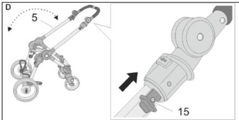
Beidseitig am Schwenkschieber die Sicherung (15) in Pfeilrichtung ziehen und gezogen halten, der Schwenkschieber kann in die jeweils andere Position geschwenkt werden.
