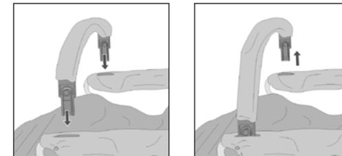
Izbīdiet ieliktna detaļas uz aizsargstieņa caur atverēm sēdekļa pārsegā un iebīdiet zem tā esošajās ligzdās, kas atrodas roku balstos. Pārliecinieties, vai aizsargstienis ar klikšķi ir fiksējies savā vietā abās pusēs. Lai aizsargstieni noņemtu, nospiediet atbrīvošanas pogas uz ieliktnu detaļām. Lai atvieglotu bērnam iekāpšanu ratiņos un izkāpšanu no tiem, pietiek, ja atbrīvojat un uzlokāt vienu stieņa pusi.
