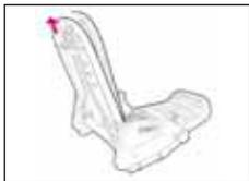
Potiahnite poistku na opierke chrbta a zmeňte jej uhol sklopenia (4 polohy sedenia a ležania + poloha sklopenia úplne dopredu).
