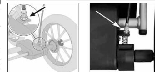
Se vi accorgete di un cambiamento dell'effetto di frenatura/stazionamento, allora per prima allentare il controdado per potere eseguire delle regolazioni alla vite di regolazione (svitare). Alla fine fissarle di nuovo il controdado.
