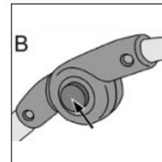
Maintenir les boutons de réglage enfoncés des deux côtés et modifier la hauteur du coulisseau dans la position souhaitée.
