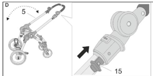
För låsspärren (15) i pilens riktning på båda sidor av handtaget och håll inne. Handtaget kan nu fällas ihop.
