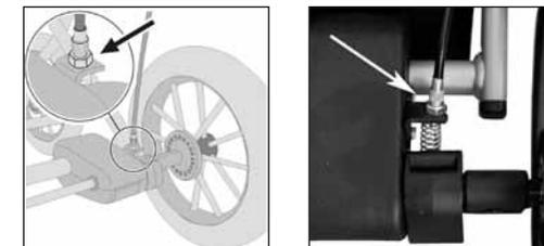
Si vous deviez remarquer une modification de l'effet du frein de stationnement, alors desserrez d'abord le contre-écrou afin d'effectuer les réglages sur la vis (desserrer). Ensuite refixer le contre-écrou.
