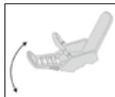
Tirare verso l'alto il dispositivo di bloccaggio dello schienale per regolare l'inclinazione (4 posizioni seduto/sdraiato + la posizione di chiusura davanti)
