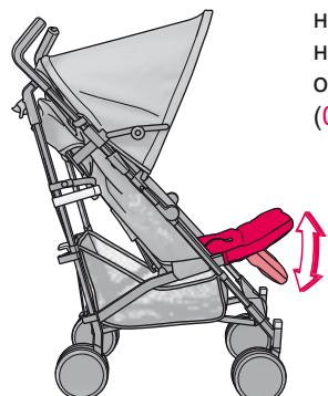
Чтобы открыть фиксатор, одновременно нажмите на левый и правый рычаг (06) на нижней стороне опоры для ног. Переместите опору для ног (07) вниз и отпустите рычаги (06).
