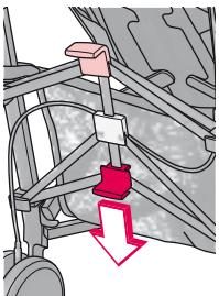
Полностью вдавите нижнюю кнопку TWINLOCK (12) вниз, чтобы фиксаторы закрылись со щелчком.
