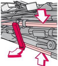
Сначала откройте транспортировочный фиксатор, скваж трубы и переместив рычаг фиксатора (11) наружу.
