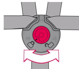
На задней стороне замка ремня находится защитный фиксатор. Для активации или деактивации его нужно повернуть. При активном защитном фиксаторе открыть механизм замка нельзя.
