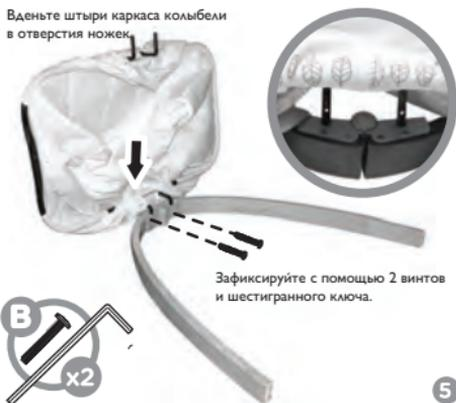
Зафиксируйте с помощью 2 винтов и шестигранного ключа.
