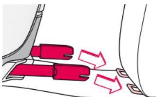
Оба адаптера TWINFIX (10) следует надвигать на крепления ISOFIX автомобиля до тех пор, пока не будет слышен щелчок фиксирующих механизмов.
