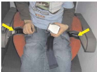
Führen Sie die beiden Enden des Beckengurtes in die Gurtführungen am Sitzteil ein.
