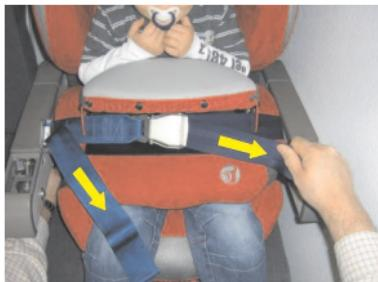
Straffen Sie die beiden losen Enden der Gurte. Positionieren Sie das Gurtschloss in der Mitte des Fangkörpers, dass es gut erreichbar ist.
