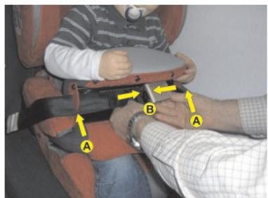
Setzen Sie Ihr Kind in den Kindersitz und schieben Sie den Fangkörper in die Führungsschlitte am Sitzteil.
