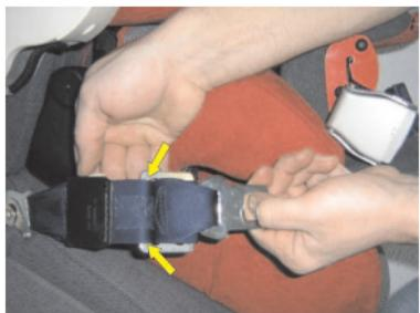
Arrotolare la riduzione cintura ancora una volta e bloccare la parte finale con i ganci davanti.
