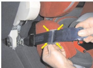
Inserire la riduzione cintura all'interno delle guide fino a quando i 4 ganci sono dietro la cinta (frecce gialle).
