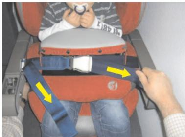
Stringere entrambe le estremità della cintura allentate. Posizionare la fibbia della cintura al centro del cuscino addominale, in modo che sia facilmente accessibile.
