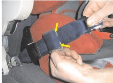
Rollen Sie den Gurtverkürzer einmal auf und fädeln Sie dann das lose Ende des Gurtes hinter die freien Haken ein.
