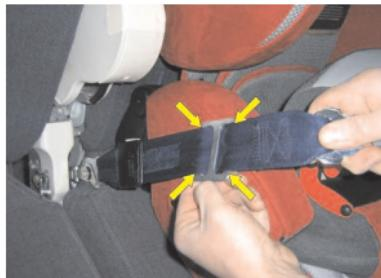
Fädeln Sie den Gurtverkürzer auf den Gurt bis alle 4 Haken hinter dem Gurt liegen (gelbe Pfeile).
