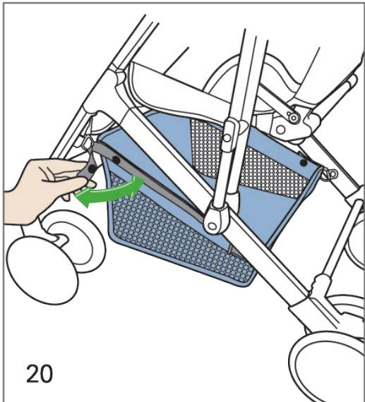
Снимите корзинку, вытащив концы фиксирующих ремешков корзинки из колечек на рамке.
