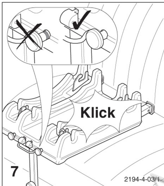
Вставьте коннекторы модели "Isofix" в скобы модели "Isofix" для носки, при этом надо, чтобы коннекторы защёлкнули. Красные маркировочные пункты на кнопках для разблокировки не должны при этом быть видимыми. Потягивая модель то в одну, то в другую сторону, проверьте, защёлкнул ли при этом механизм.
