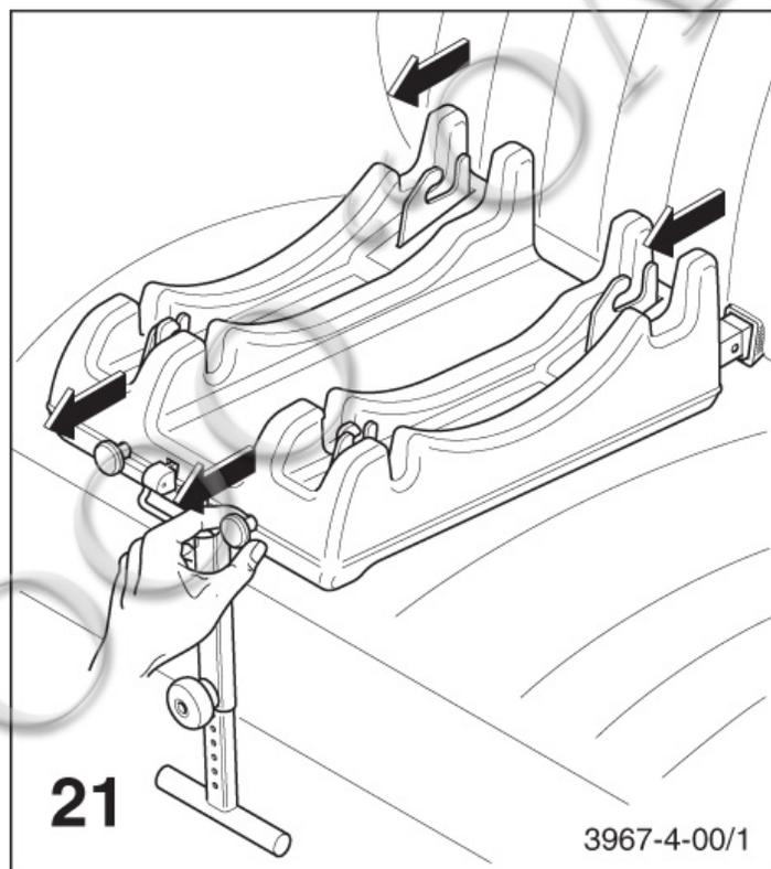
Разъедините разъёмные «Isofix»-элементы путём подтягивания обеих кнопок деблокировки.
