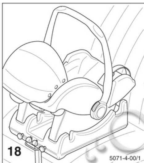
При транспортировке в автомобиле ручка для переноски должна быть в вертикальном положении.
