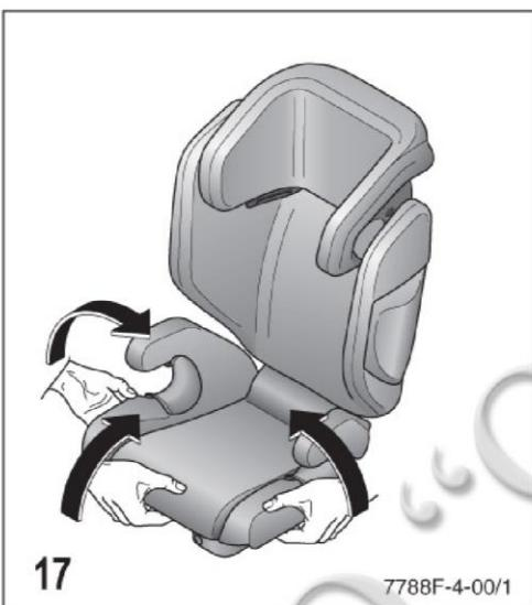
Вытяните нижние пластиковые планки из соответствующих прорезей. Снимите чехол снаружи, начиная с направляющих ремня. Сами направляющие при этом демонтировать нельзя.
