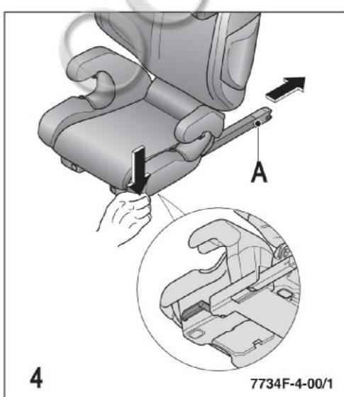
Для установки автокресла необходимо выдвинуть коннекторы Seatfix (A). Для этого нажмите на запорные рычаги, расположенные по бокам сиденья автокресла, и вытяните коннекторы Seatfix назад до упора.
