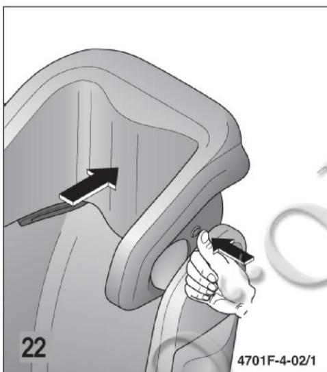
Нажатием спускного клапана можно плавно установить положение для отдыха, позволяющее откинуть голову назад.
