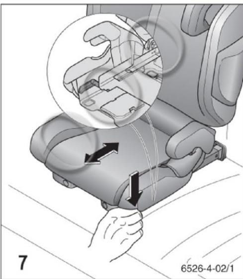
Положение для отдыха устанавливается путем регулировки коннекторов Seatfix. Для этого нажмите на запорные рычаги и приведите спинку в желаемое наклонное положение, двигая автокресло вперед или назад.
