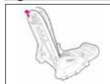
Tirare verso l'alto il dispositivo di bloccaggio dello schienale per regolare l'inclinazione (4 posizioni seduto/sdraiato + la posizione di chiusura davanti).
