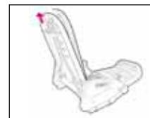
Tirar del dispositivo de bloqueo del respaldo hacia arriba para ajustar la inclinación (4 posiciones de reclinación del asiento + posición de plegado completamente hacia delante).
