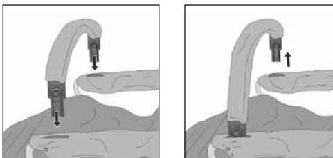
Stikk festene av frontbøylen gjennom åpningene i stettrekket og inn i åpningene på armlenene. Pass på at frontbøylen smekker på plass på begge sider. Trykk på utløserknappene på bøyelendene for å ta den av. For å gjøre det enklere for barnet å komme inn og ut, er det tilstrekkelig å bare løsne en side av bøylen, og så vippe den oppover.
