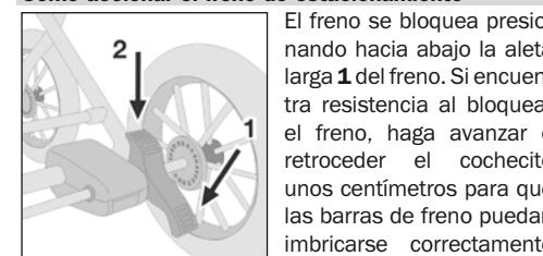
que el freno se ha enclavado correctamente. Para soltar el freno hay que presionar con el pie la aleta corta **2** del freno.
