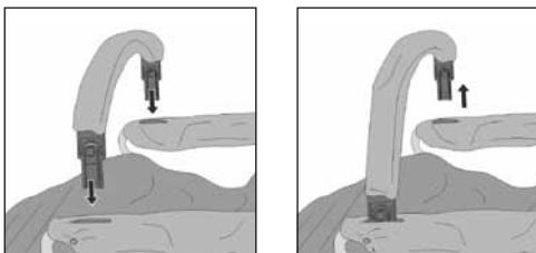
Introduisez les parties repliables de l'arceau de sécurité par les rainures de la garniture de siège dans les guides sous-jacents dans les accoudoirs. Veillez à ce que l'arceau de sécurité s'encliquète des deux côtés. Afin d'enlever appuyez sur les boutons de déverrouillage sur les parties repliables. Afin de faciliter la montée et la descente de voiture de votre enfant, il suffit de desserrer un côté de l'arceau et de relever.
