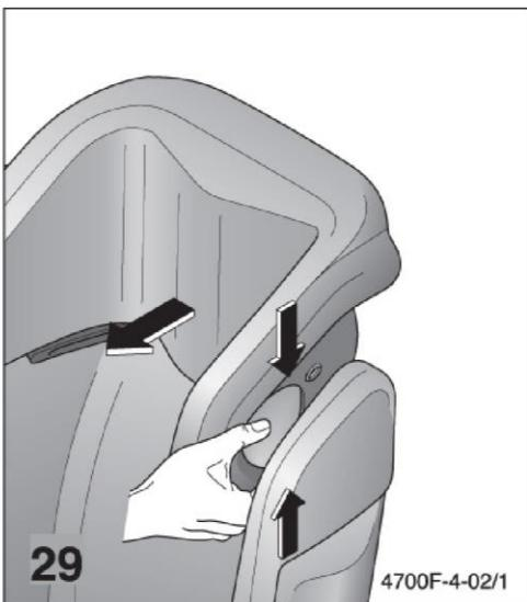
Плавно регулируемая глубина подголовника обеспечивает безопасное положение во время сна ребенка, так как голова спящего ребенка не падает вперед, покидая защитную зону подголовника. Для обеспечения оптимальной безопасности приведите регулируемую надувную подушку в стандартное «полное» состояние (15–20 нажатий ручного насоса).
