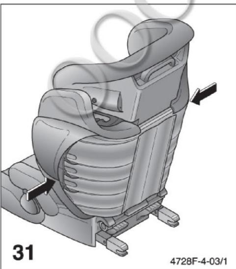
Боковые ребра жесткости вместе с чехлом обеспечивают повышенный уровень защиты Вашего ребенка при боковом столкновении и обеспечивают комфортную заднюю вентиляцию всей спинки автокресла.
