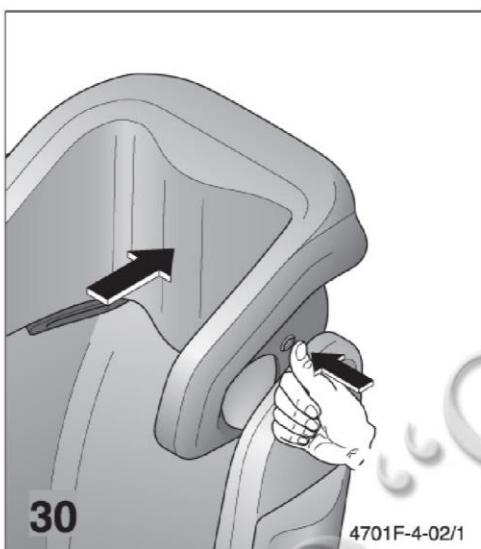
Нажатием спускного клапана можно плавно установить положение для отдыха, позволяющее откинуть голову назад. Процесс выпуска воздуха можно ускорить, нажав на надувную подушку.
