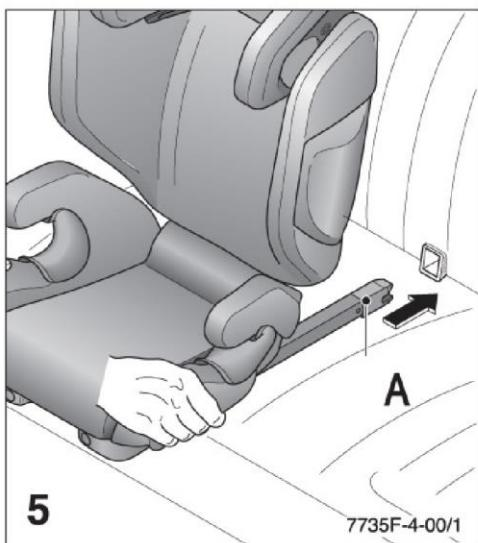
Наденьте коннекторы Seatfix (A) на скобы крепления Isofix, при этом на обоих коннекторах должна быть видна зеленая маркировка. Проверьте надежность фиксации, потянув с двух сторон за поверхность сиденья.
