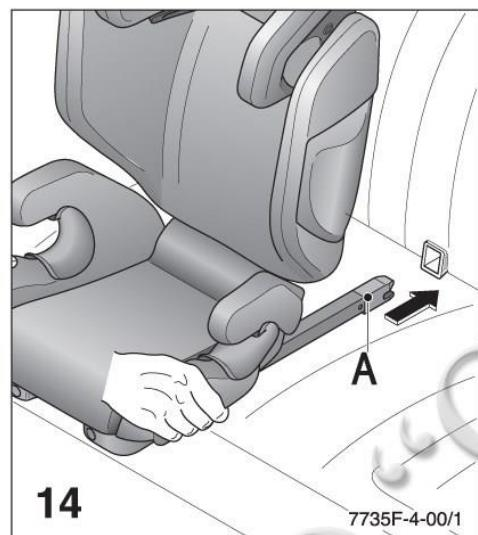
Наденьте коннекторы Seatfix (A) на скобы крепления Isofix, при этом на обоих коннекторах должна быть видна зеленая маркировка. Проверьте надежность фиксации, потянув с двух сторон за поверхность сиденья. Теперь, нажимая на запорные рычаги, передвигайте детское автокресло по направлению к сиденью автомобиля до тех пор, пока его спинка не будет плотно прилегать к спинке сиденья автомобиля.
